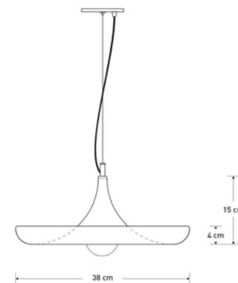
Matériaux: Aluminium repoussé avec revêtement par poudre, câble en acier inoxydable, structure dorée au nickel
