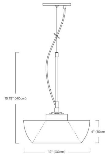
Matériaux: Aluminium repoussé et moulé avec revêtement par poudre, verre poli et structure en acier inoxydable
